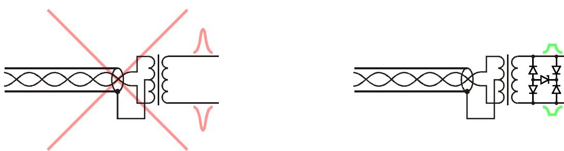
6. Экранированный шнур, соединяющий устройство с защищаемым оборудованием, обеспечивает дополнительное подавление синфазной помехи, проникающей через межобмоточную емкость разделительного трансформатора.
