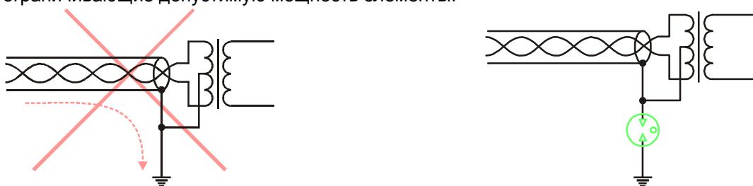
3. Цепь подавления помехи обеспечивает нейтрализацию импульсной помехи, возникающей при срабатывании газоразрядного прибора.
