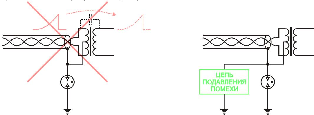
4. Шунтирующее газоразрядное устройство варистором обеспечивает "мягкое" стекание электростатических зарядов, оседающих на кабельном сегменте при выпадении осадков и индуцируемых грозовыми облаками. Это снижает нагрузку на газоразрядный прибор и уменьшает потери данных в условиях высокой напряженности электростатических полей.
