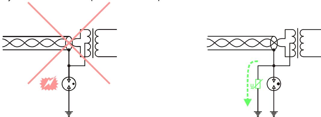
5. Быстродействующие импульсные диоды совместно с TVS-диодом обеспечивают эффективное подавление противофазной помехи до безопасного уровня. Низкая барьерная емкость импульсных диодов обеспечивает высокую степень согласования сигнального тракта даже на высоких частотах, при передаче данных на скорости 100Мб/С
